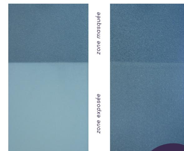
\*Test QUVB 313 (norme 4892-3). L'enceinte de vieillissement accéléré reproduit artificiellement le spectre solaire complet. Elle simule, en quelques heures ou semaines, les détériorations et les dommages provoqués par l'irradiation solaire et les intempéries en extérieur sur plusieurs années.
